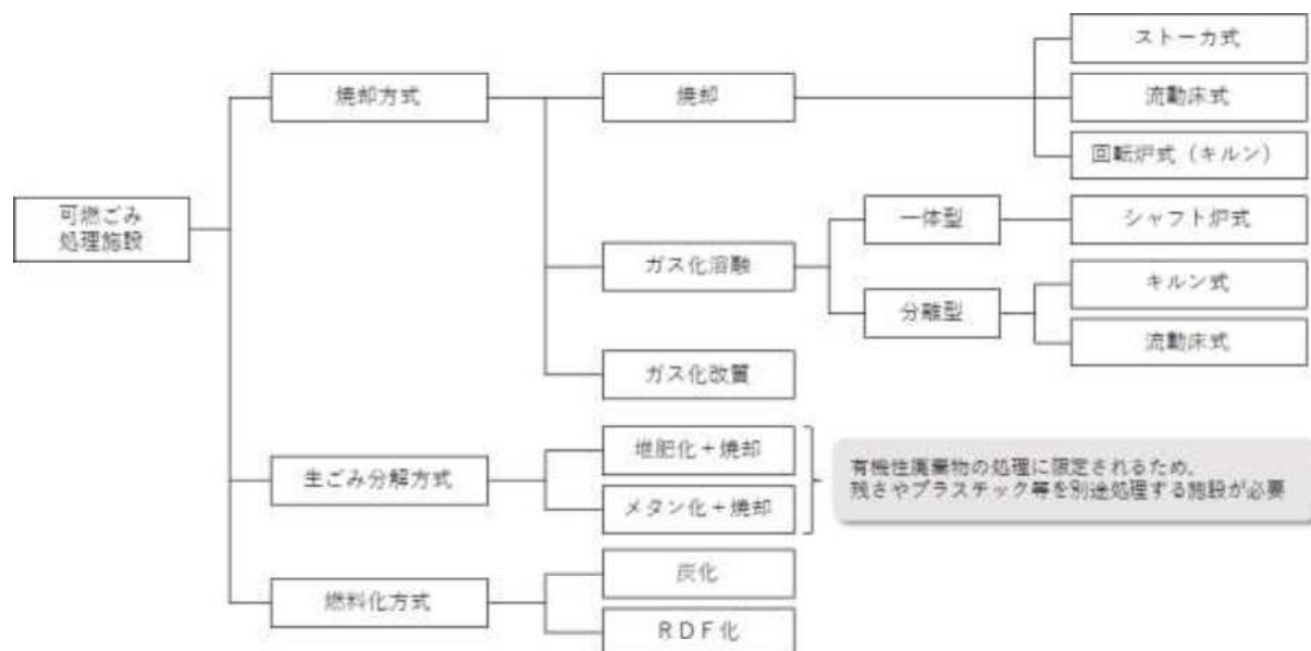
図 5-2 可燃ごみの処理方式
