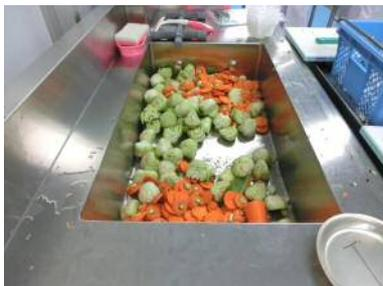
「下処理用粉碎流し台」に野菜の廃棄部分を投入すると粉碎機で細かくし、野菜くずは、流水とともに約50メートル離れた「脱水機」まで調理場床下のパイプの中を流れていきます。
