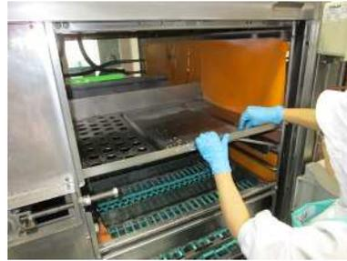
大型洗浄機器の内部は、高圧洗浄機やたわしなどを使い、隅々まで洗浄します。
