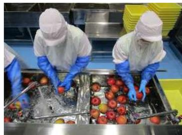
第3槽・第4槽では、流水で洗浄します。
