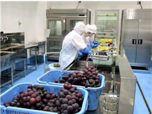
ぶどうは加熱処理を行うことができないので、いつもの3回洗浄に加えて電解次亜水につけて除菌もします。
