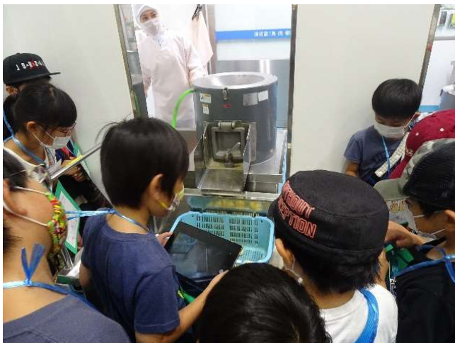
野菜の皮むきの機械。 上の穴からじゃがいもを入れると横の穴から皮がむ
