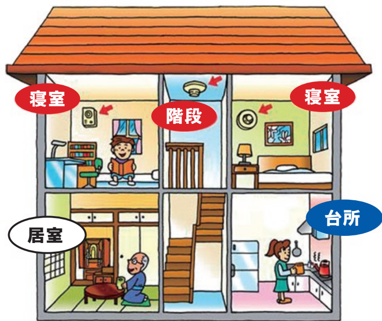
住宅用火災警報器の設置例
