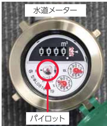
パイロットは量水器ボックスの中にある水道メーターの中央付近にあります。水が水道メーターを通過すると、パイロットが回転する仕組みです。
