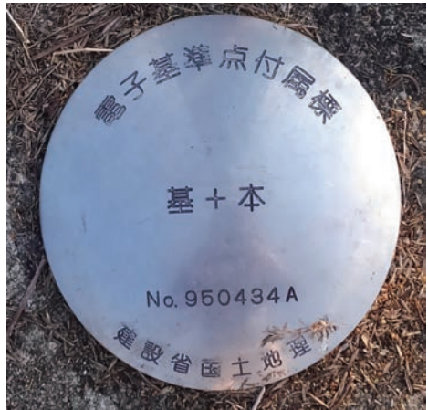
電子基準点の下にあるプレート
